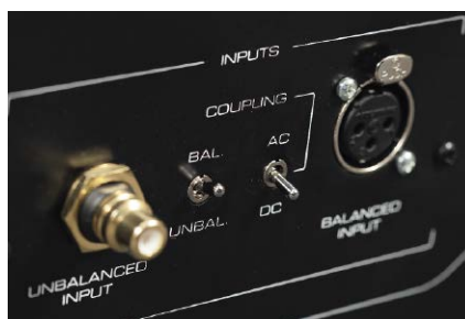
Wejścia są dwa, RCA oraz XLR, towarzyszą im przełączniki: aktywowanego wejścia oraz trybu pracy AC lub DC.
